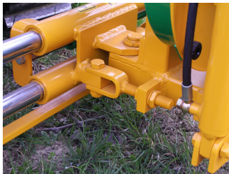
Snodo di disassamento dell'albero spollonante rispetto al filare. Adjustable joint. The tipping shaft may be levelled to the row of vines.
