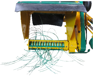
Sistema con albero avvolgifilo. Sull'albero vengono raccolti spezzoni di filo di lunghezza pari a 4 metri. Sono inseriti a gruppi di 3 nei fori dell'albero.
