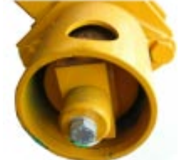
Snodo di disassamentamento dell'albero spollonante rispetto al filare.
