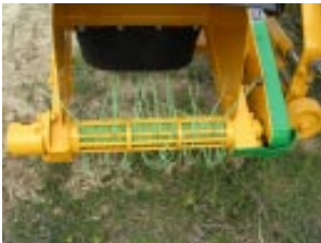
Sistema di rullo spollonante costituito da due alberi coassiali. Sull'albero interno vengono raccolti spezzoni di flagelli di lunghezza pari a 3 metri ciascuno, per un totale di 180 metri di filo di nylon.
