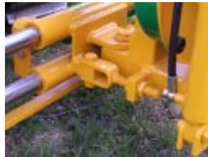
Particolare dello scatto per l'allungamento del filo tramite un'unica e semplice manovra.
